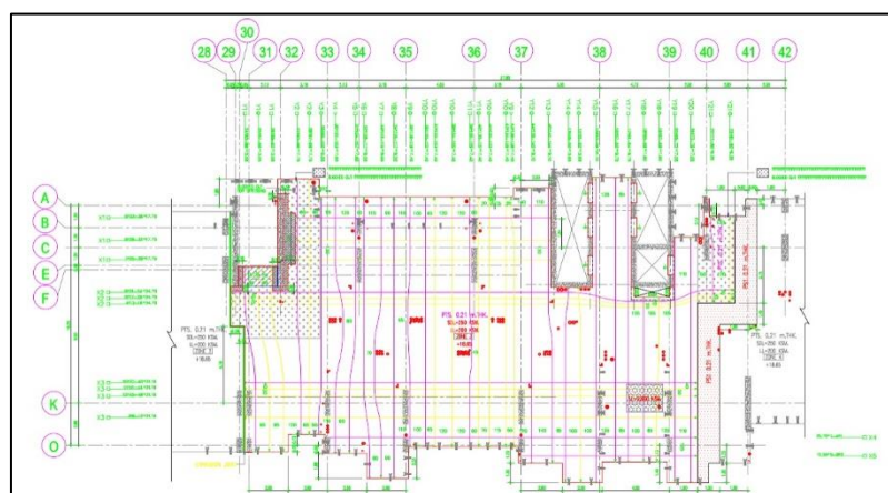
รูปที่ 4.34 แบบโครงสร้างแสดงขนาดความยาวและตำแหน่งลวดสติงพื้นคอนกรีตลวดอัดแรง
