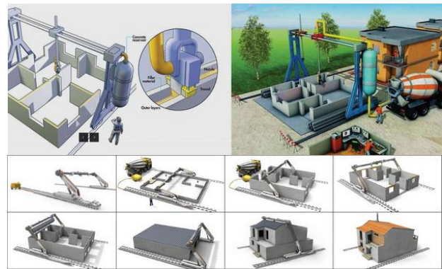
รูปที่ 3 วิธีการพิมพ์บ้าน 3 มิติ ด้วยเครื่องพิมพ์คอนกรีต เคลื่อนที่ตามแกน X,Y,Z
